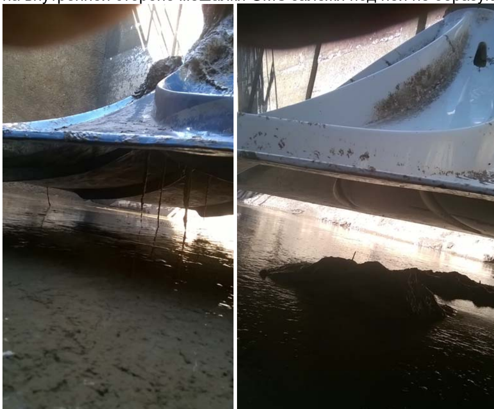
Рис.2. Фотографии отложений под мешалкой Н.....С (справа) и отсутствия залежей под мешалкой GMS (слева).
