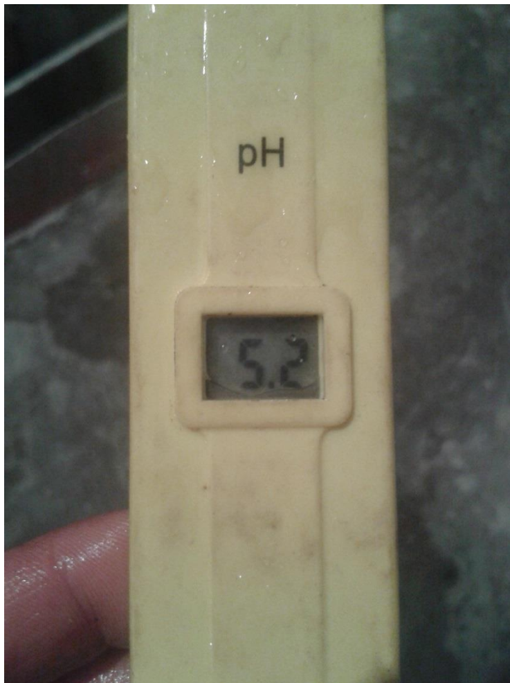
Рисунок 8 Контроль pH показателя воды.
