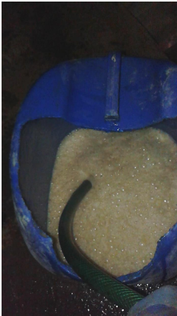
Рисунок 6 Сброс излишков пены в дополнительную емкость
